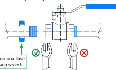
4. Revisar la alineación de las tuberías. La válvula no absorbe las diferencias. Las distorsiones resultantes de una incorrecta alineación pueden causar problemas de sellado, dificultades al maniobrar y hasta roturas.
