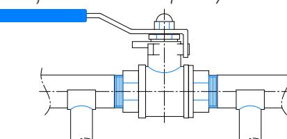
NOTA IMPORTANTE: El diseño de la instalación debe evitar todo tipo de tensiones para no dañar a la válvula y mantenerla operativa en todo momento.
