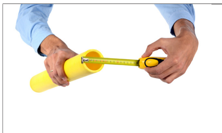
1. Medir el diámetro del tubo. Measure diameter of the pipe.
