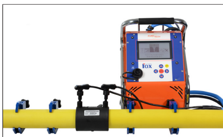
11. Inicio de la soldadura. Start welding.
