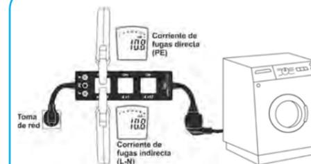
LINESPLITTER incluye además otro anillo (mA PE y mA L-N – ver figura sup.) para una cómoda medida de la Corriente de Fugas directa con respecto a tierra (sobre el conductor PE) e indirecta/diferencial sobre los conductores activos de Fase y Neutro (L-N) sin necesidad de abrir circuitos ni cortar cables.
