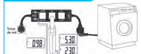
LINESPLITTER permite también la realización de medidas de tensión L-N, L-PE o N-PE e Intensidad a la vez (vea la figura superior) por lo que si utilizamos una pinza Vatimétrica podremos además de ver la tensión e intensidad, el consumo generado por el receptor en examen.
