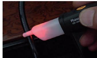
Encendido LED rojo con tensión detectada
