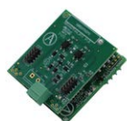
Pasarelas de aerotermia
