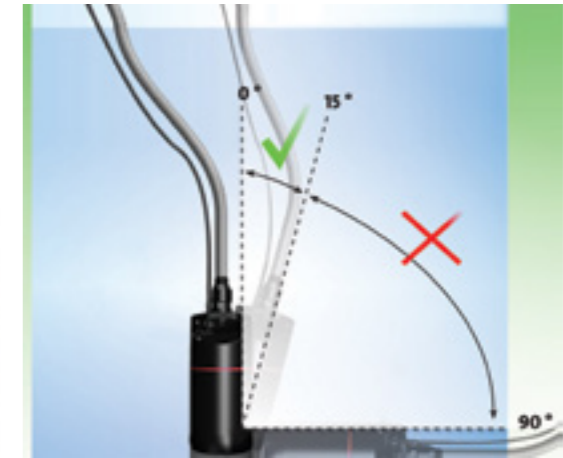
Versión SB: Instalación vertical o ligeramente inclinada - No se puede instalar horizontalmente.
